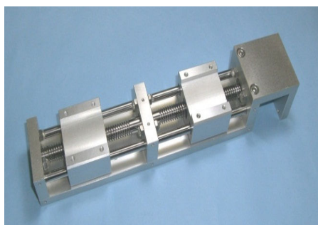
①送りねじ:TMC10(同軸左右ねじ)使用
